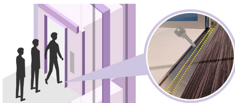
（図3）ドアが開くとエレベータと建物の間のすき間をふさぐ
