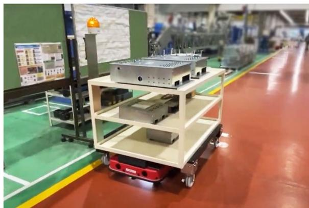
床面に貼り付けた指示コードに沿って工場内を走行し、目的地まで移動します。
