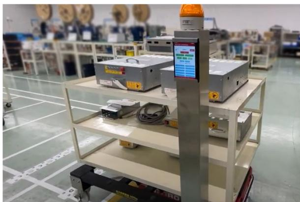
次の工程に運びたい完成部品を配送ロボットに積み込みます。
