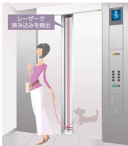
ドアを閉じる際のペットのリードや点滴チューブなどの細長いものの挟み込みをレーザーで検出。液晶表示と音声案内で注意を喚起し、ドアを反転して開きます。
