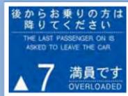
かご内には見やすい液晶インジケータを採用。緊急時には液晶画面にさまざまな情報を表示し、同時に音声による案内も行います。また、巻上モータやドア駆動モータも交換しますので、安定した性能が得られます。
