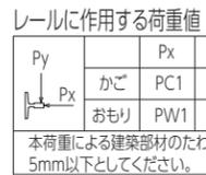
本荷重による建築部材のたわみは5mm以下としてください。
