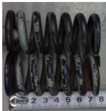
図15 事故機の左右ブレーキスプリング (自然長 75mm)
