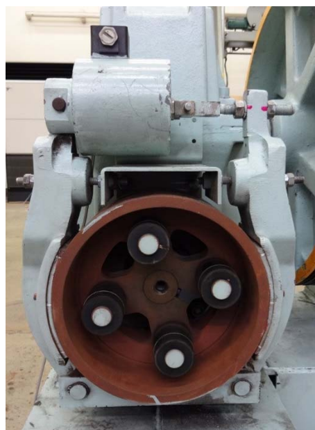
図5 W型巻上機のブレーキの写真
