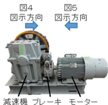
図5 W型巻上機のブレーキの写真
