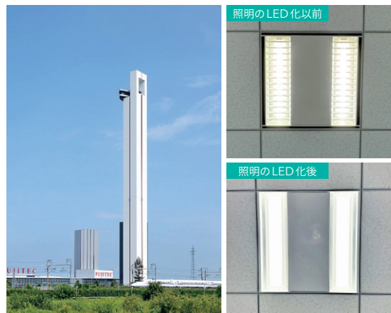
本社・ビッグウィングの研究塔内の照明器具はLED化が完了
